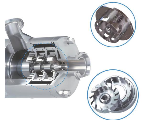
KML3型是一种三级高剪切在线分散乳化机，用于生产非常精细的乳液和悬浮液。工作腔内的剪切力大大增加了物料的输送，加快了单分子和高分子物质的溶解速度。三级定子组合（分散头）确保液滴或粒度小且分布范围很窄，超越了传统剪切泵和胶体磨的功能。此工艺可以使单次混合的混合物长时间保持稳定，尤其是混合乳化液时。
