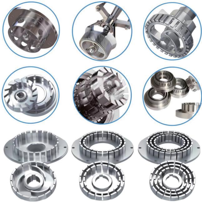
KPH具有基于应用的各种配置的工作头（转子/定子），如叶片、爪式、圆孔、长孔、网状、直槽、斜槽、粗齿、中齿、细齿、单层、多层等齿形结构。不同齿形结构的工作头，对物料的剪切力、流向、流量有所不同，具体选择取决于物料特性和生产工艺。
