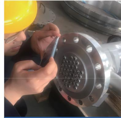
带静态混合元件的 KPH管束热交换器
