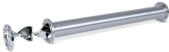
可以由金属合金（碳钢、不锈钢、双相钢、钛合金与哈氏合金等）制成，也可以用塑料材质（PVC、PVDF、PP、聚丙烯、聚四氟乙烯等），混合器两端还可以是直管，也可以是螺纹、法兰、卡箍、活接等连接方式，也可带冷、热夹套。混合单元通常被焊接在管道中，特殊条件下也可以做成活动式。不同种类的静态混合器就在于内部混合单元的差异，包括混合单元数量、材质及规格的差异。
