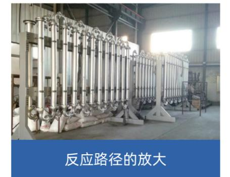
由于其模块化设计，KPH活塞流反应器可安全扩展，可同样用于实验室、中试和生产规模。根据工艺和程序，反应系统可以从小系统放大或直接开发。
