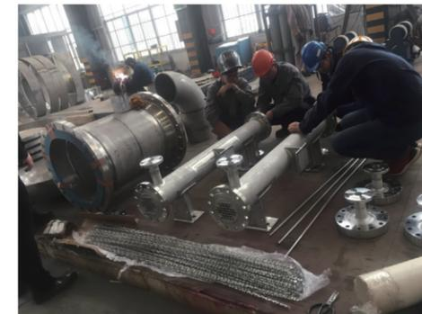
只有在超过KSK、KSX和KSL静态混合结构的能力时才使用交叉管设计。当过程流体的粘度随温度降低而急剧增加时，它最常用于粘性材料的冷却。由于其单管设计和倾斜板结构，消除了平行管多管热交换中出现的流体分布不均。当需要同时混合、反应和塞流特性以及反应材料的加热/冷却时，交叉管设计也可用作聚合反应器。
