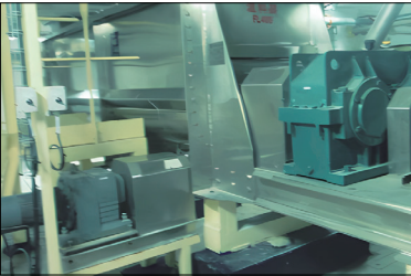
混合后的物料经螺旋输送机 输送至后道工序
