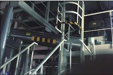
变性淀粉由螺旋输送机 输送至抛扬机进入工艺管道
