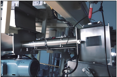
子母螺旋输送机（山梨醇定量转移输送）
