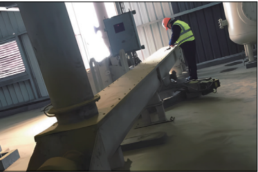
超长螺旋输送机（输送玉米麸皮）
