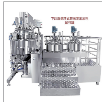
下均质循环式管线泵出料+配料罐
