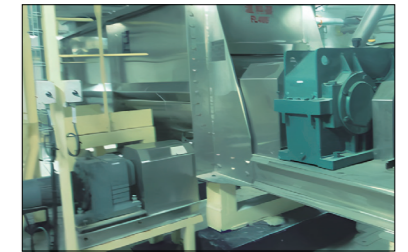
混合后的物料经螺旋输送机输送至后道工序
