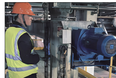
螺旋输送机（喷涂硬质合金用于输送硅藻泥）
