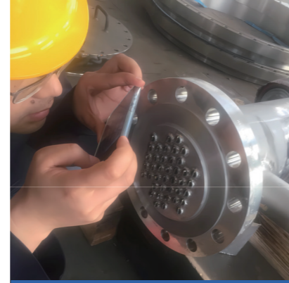
带静态混合元件的 KPH管束换热器
